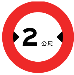
車輛寬度限制標誌
