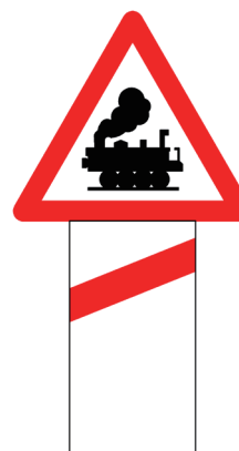
第三面 無柵門鐵路平交道
