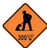
道路施工 （前方 300 公尺處）
