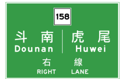
高（快）速公路出口 預告（二）
